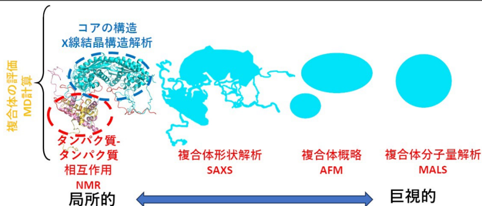
図：NMR、SAXS、MALS、AFM、MD 計算と生化学実験など複数の解析手法を組み合わせた統合的な相関構造解析法の概要図
